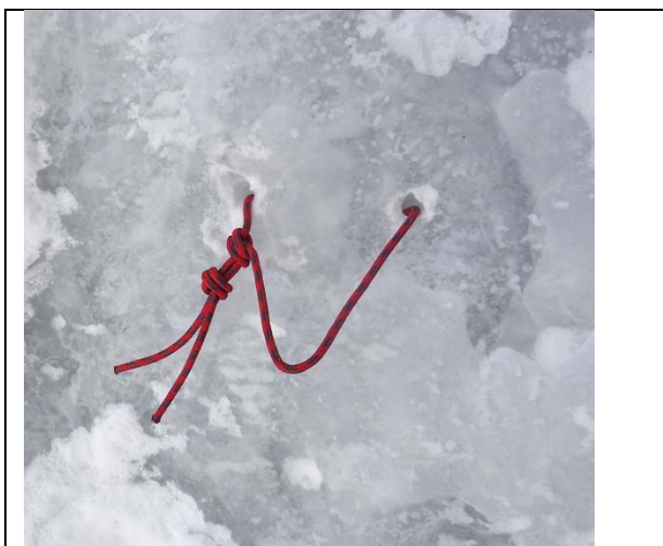
Situation finale de l'ancrage, vue de face. La cordelette est emprisonnée par un pont de glace.
